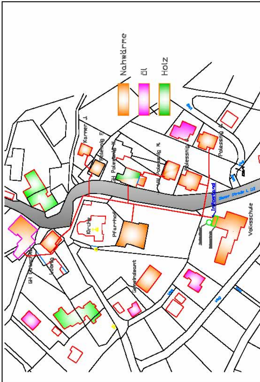
Lageplan des Biomasse-Fernwärmenetzes von Diex
