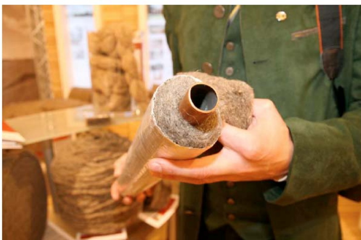
Rohrdämmung mit Schafwolle
