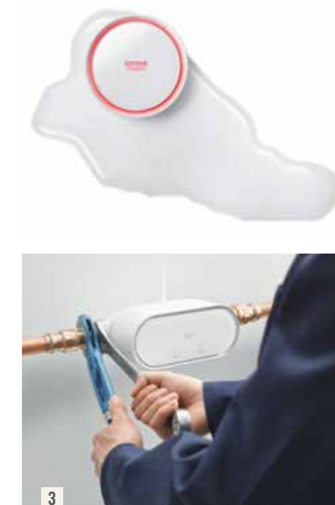
Der intelligente Wassersensor GROHE Sense (oben) überwacht Luftfeuchtigkeit, spürt Leckagen auf und schlägt Alarm. Der Wächter GROHE Sense Guard (unten) wird an die Hauptwasserleitung montiert und unterbricht den Zufluss, wenn ein Leitungsschaden vorliegt. Beide sind mit der GROHE Sense App mit dem Smartphone verbunden.
